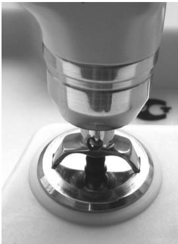
BILD 7. Kontroll av tonometerns prestanda
